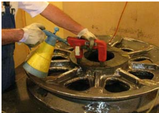
Obr. 6. Nanášení aerosolu s feromagnetickým práškem
