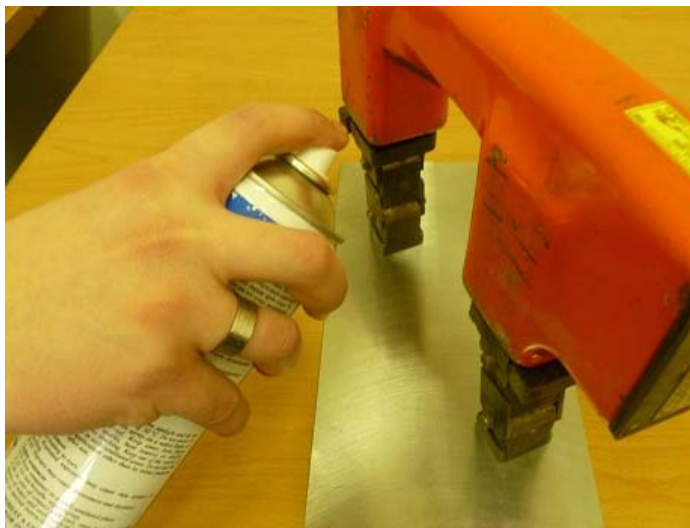
Obr. Provedení magnetické zkoušky
