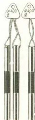
Obr. 9. Měření středního průměru závitu přes drátky Obr. 10. Měřicí drátky
