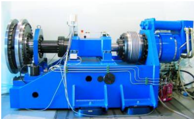
Obr. 2. Zkušební stroj pro zkoušku krutem s jmenovitým kroutícím momentem 50 000Nm, což odpovídá síle 5tun působící na páce o délce 1m
