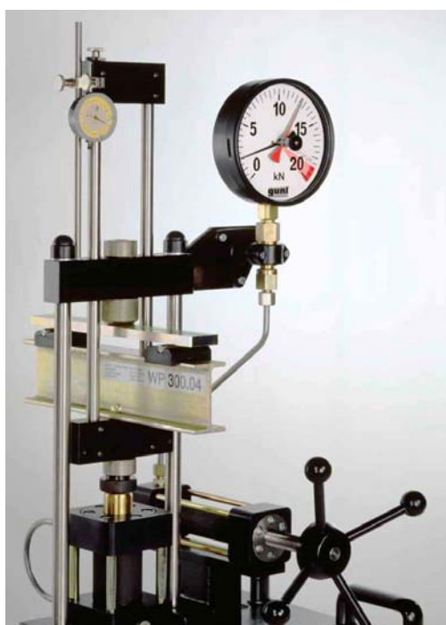
Obr. 6. Univerzální zařízení WP 300 - zkouška ohybem
