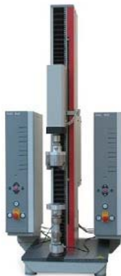
Obr. 3. Zkušební stroj Zwicky – Line pro zkoušku krutem s torzním pohonem od 2 do 20Nm. Zkušební stroj umožňuje provádět zkoušku tahem či tlakem v kombinaci s krutem
